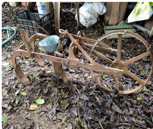
Herramientas para el cultivo de la milpa (izq.). Sembradora de tracción animal (der.).
