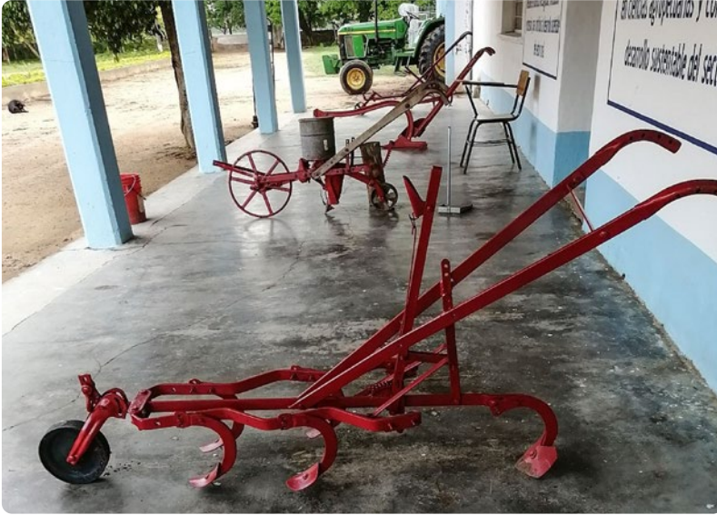
Arado extranjero: es una herramienta jalada por tracción animal y se utiliza en terrenos planos y semiplanos. Foto: Adrián Pérez de la Cruz
