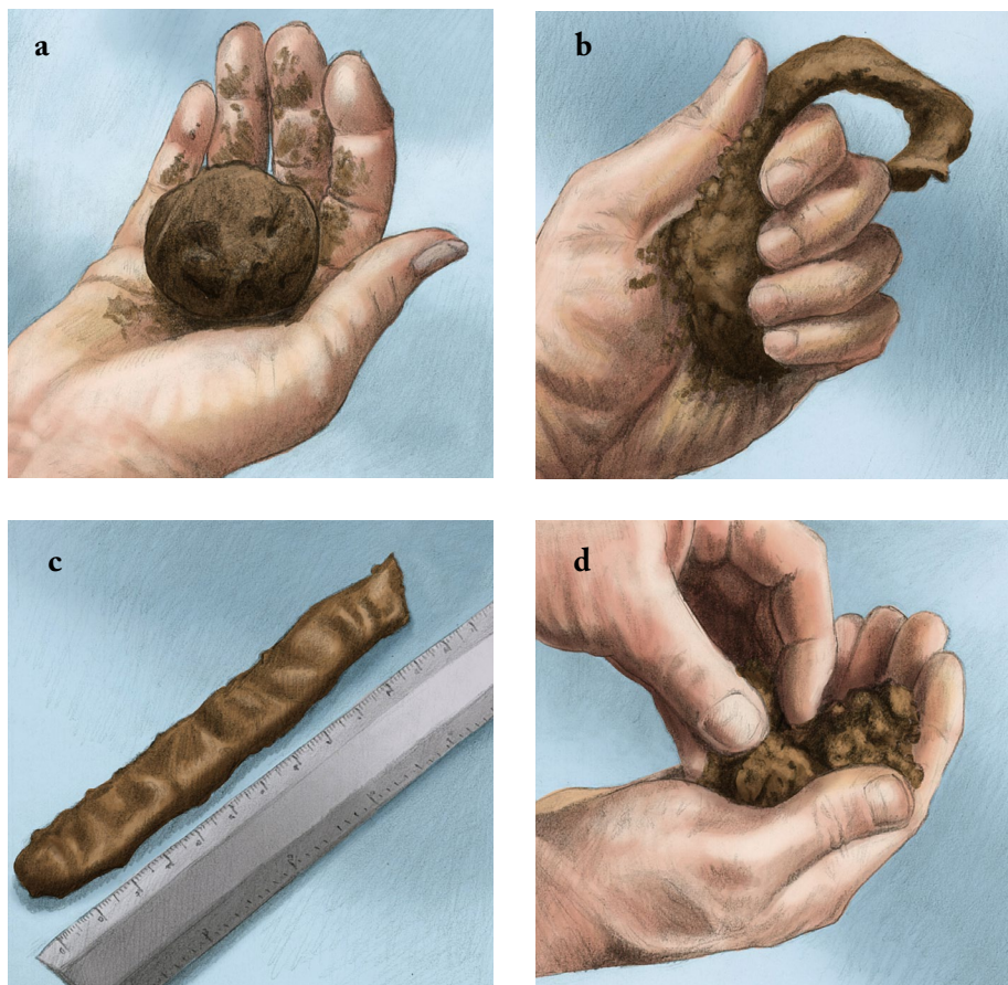
Figura 4. La textura del suelo se prueba tratando de formar una bola y una cinta de ancho y grueso uniformes.
