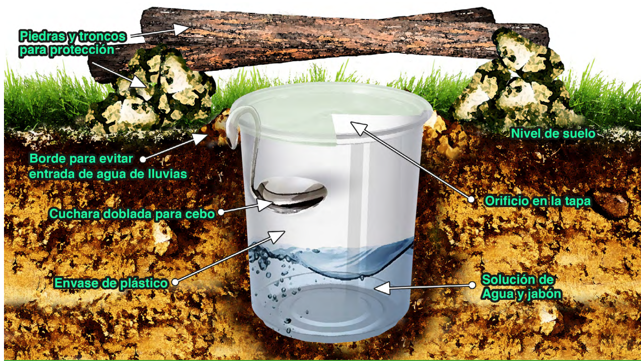
Figura 13 Modelo de trampa Pitfall. Adaptado por Rivera (L. E. Rivera, comunicación personal, 19 de marzo de 2020).
